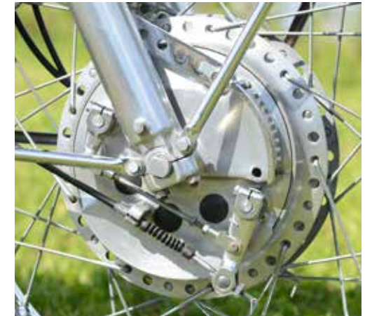
Effektiv bromsstrumma i sin tid.
