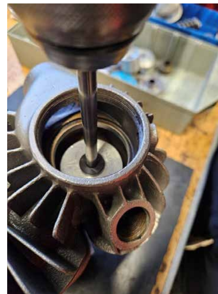
Aktuell dimension på brotsch körs igenom befintlig styrning
