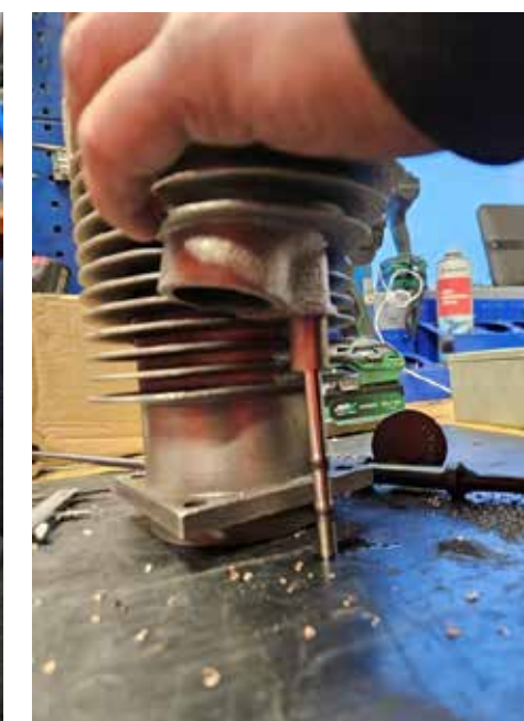
När dornet är igenom helt vet man att det är rätt dimension på styrning samt att insatsen sitter fast
