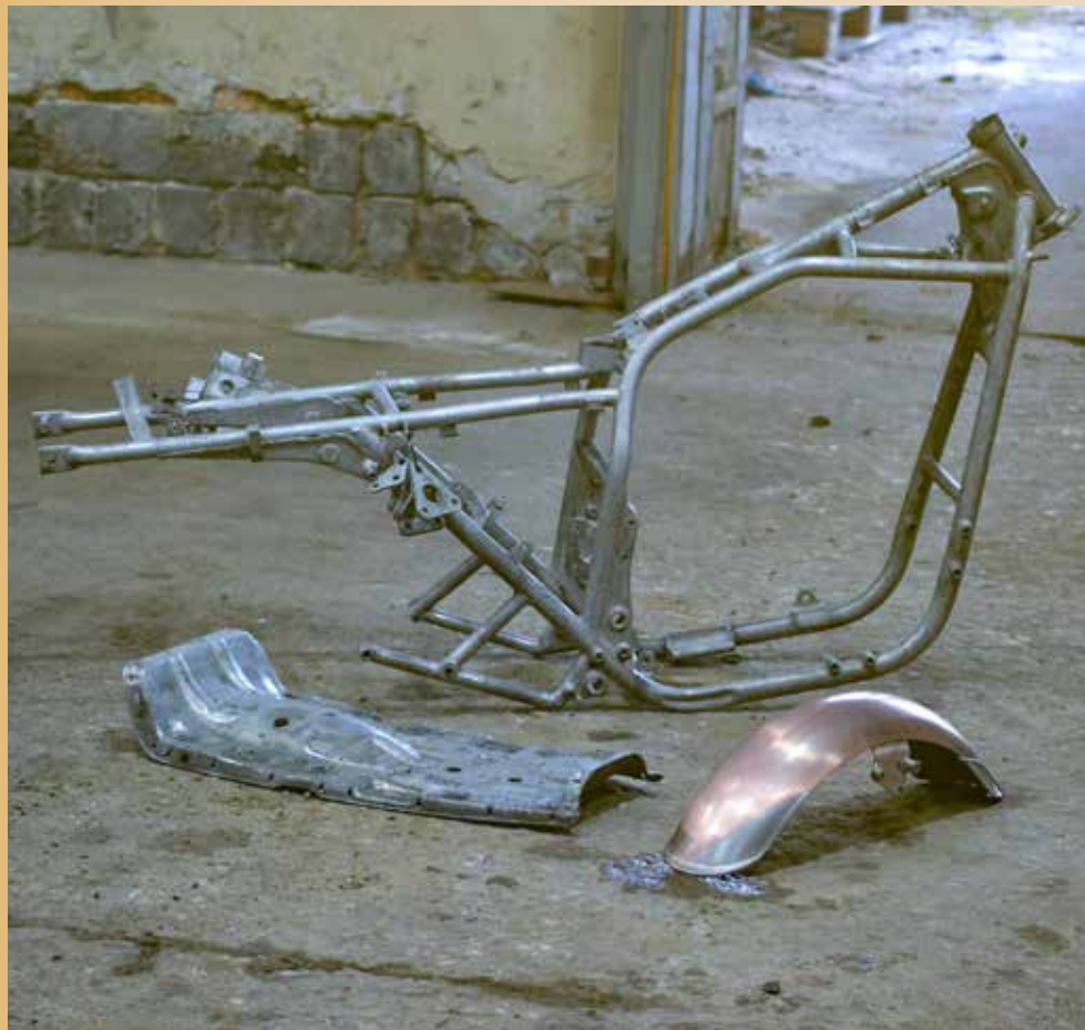
Ingen lack eller rost kvar efter en vecka i Joels häxbrygder, klart för lack.
