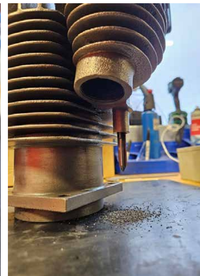
Brotschen avverkar till förbestämd diameter på hålet i styrningen
