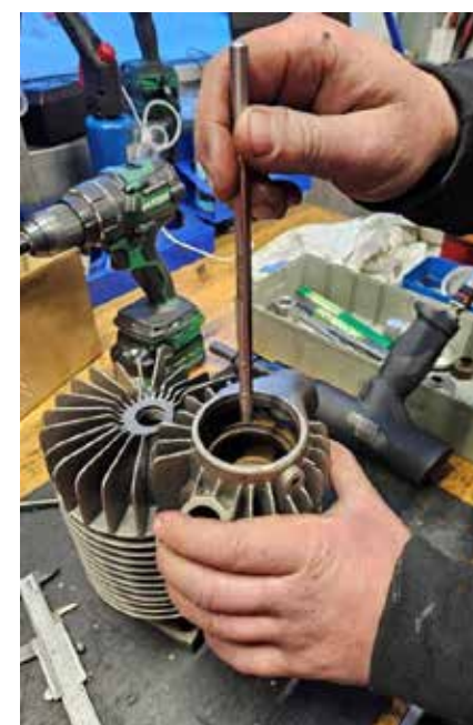
Svällningsdornet med kulformade ansatser som gör att insatsen pressas in i styrningen
