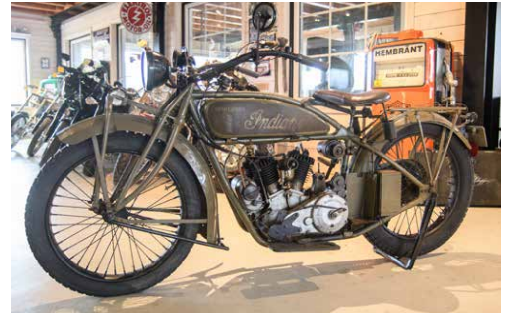
Indian Scout från 1924 hade 606 cc och en treväxlad låda. Ventilyftare och avgasspjäll samt elektriskt ljus både bak och fram.
