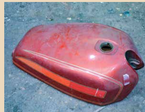
Tanken innan behandling, ser skaplig ut men mycket rost på insidan samt i behov av svetsning under.
