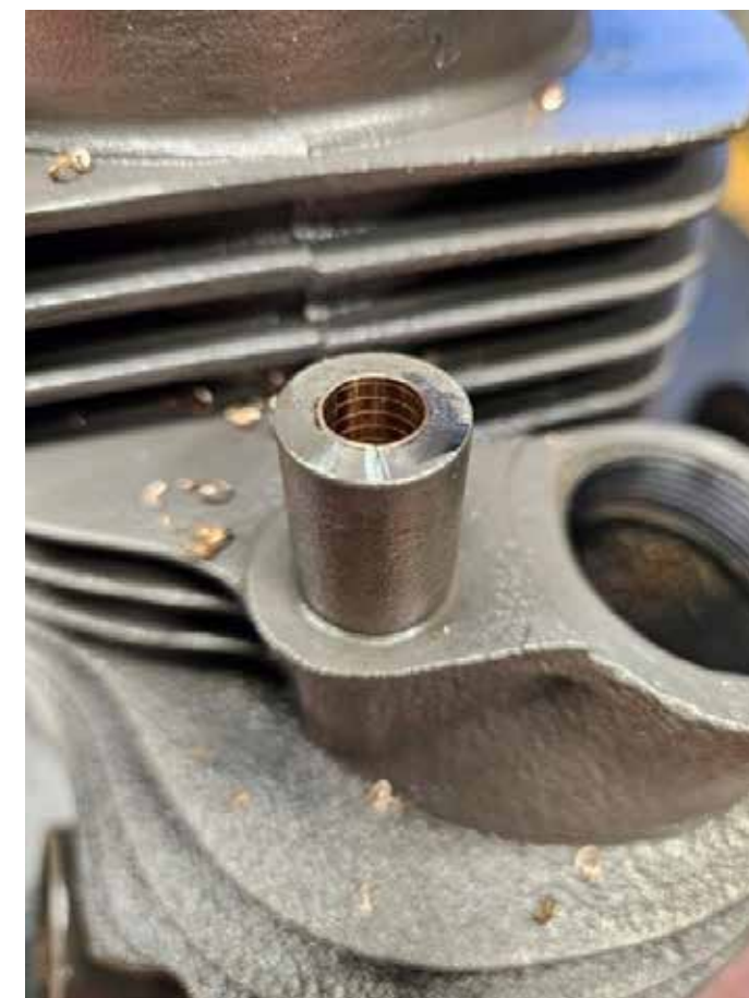
Insats på plats och anpassad till den gamla styrningens längd
