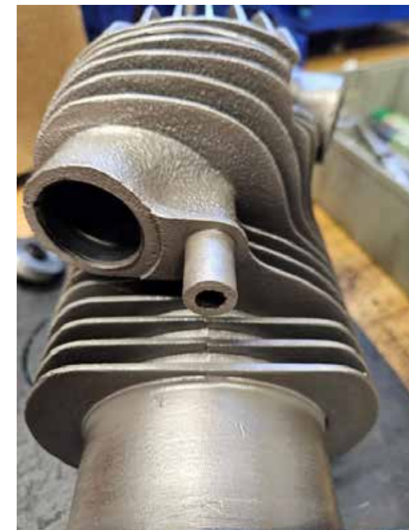
Renoveringsobjektet: cylinder till H-D halvtopp med fast styrning
