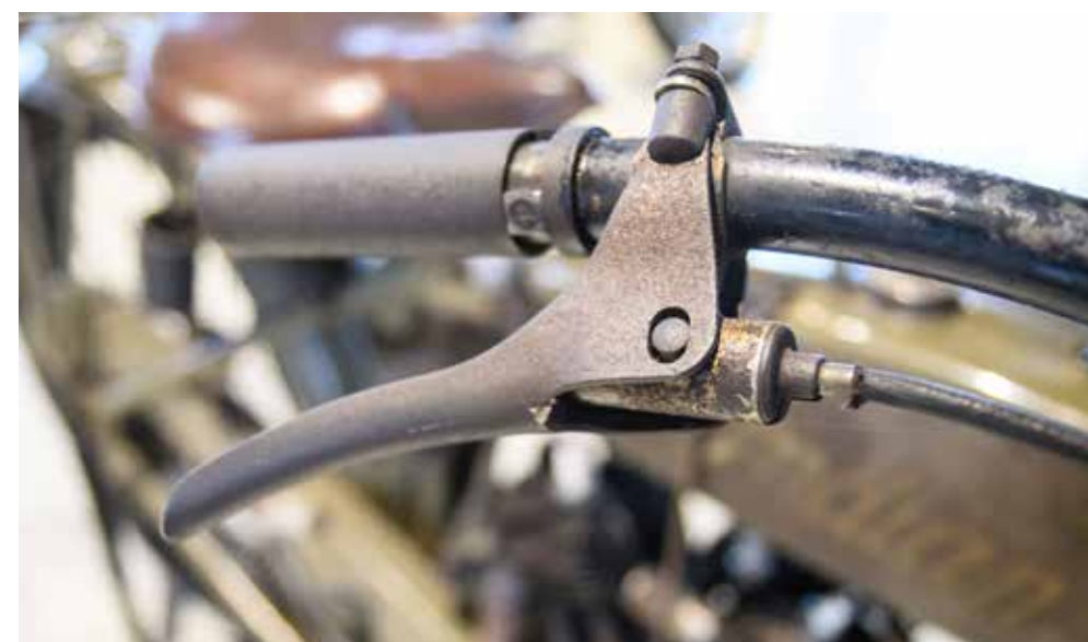
Spjällöppnare till avgasrören ifall man behöver lite extra.
