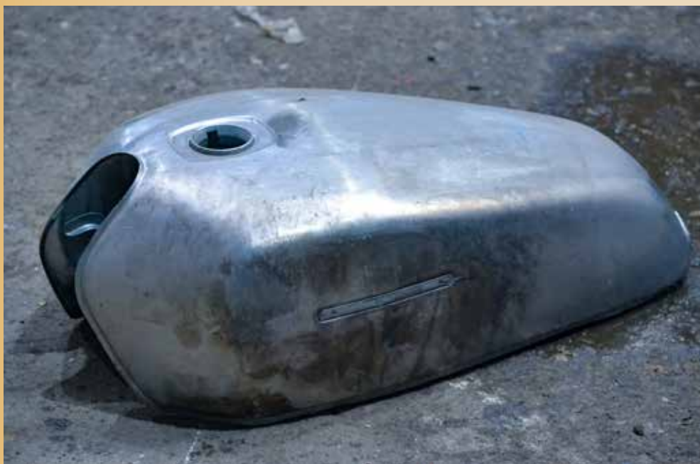
Så här fin blev tanken efter att ha badat i lut och syra ett par dygn, som ny och även rostfri på insidan.
