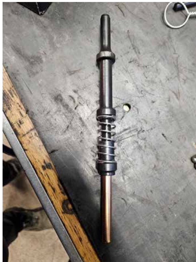
Insatsen påträdd på monteringsverktyget
